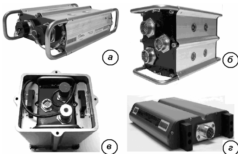
Рис. 2. Забортное полевое оборудование системы «ARAM ARIES II»: полевые приемные модули RAM – (а), межлинейные модули TAP – (б), полевой модуль с батареями в герметичном морском корпусе – (в), ионно-литиевая батарея – (г)
