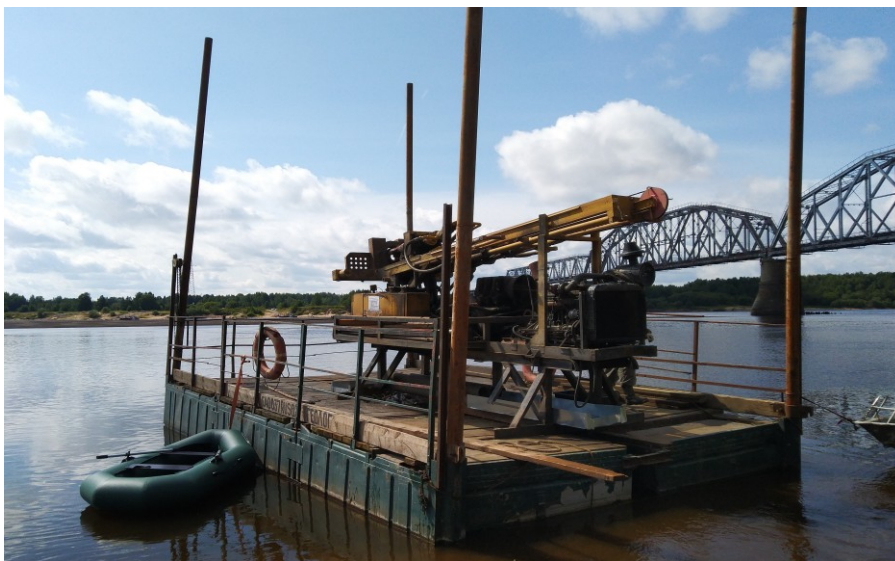
Рисунок 2 – Бурение с плавучих установок (понтон «Геолог-1» с установленной буровой установкой)
