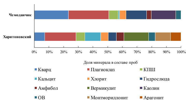
Рисунок 7 – Минеральный состав донных отложений водоемов: ОВ – органическое вещество, КПШ – калиевый полевой шпат. Представлены средние содержания
