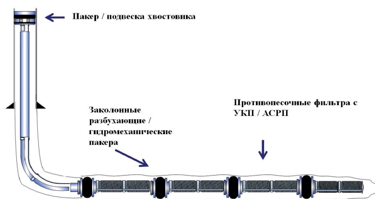
Рис. 1. Система заканчивания горизонтальной скважины
