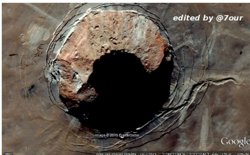
Рисунок 4 — Космический снимок (14.01.2015), показывающий кратер на месторождении Хауд Беркауи диаметром около 350 м и разломы вокруг него [6]
