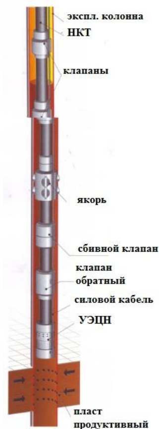
Рис. 2. Якорная компоновка для эксплуатации скважин установкой ЭЦН
