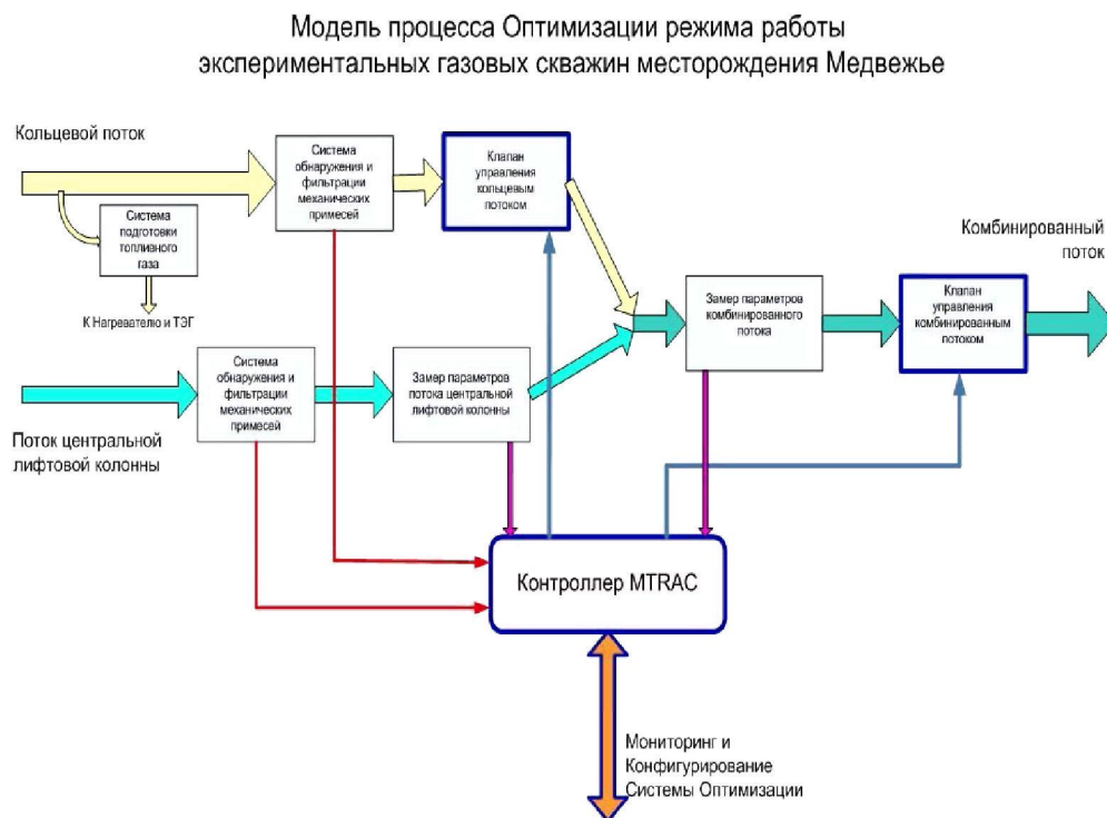
Рис. 3. Принципиальная схема работы автоматизированной системы управления концентрическими лифтовыми колоннами компании Zedi
