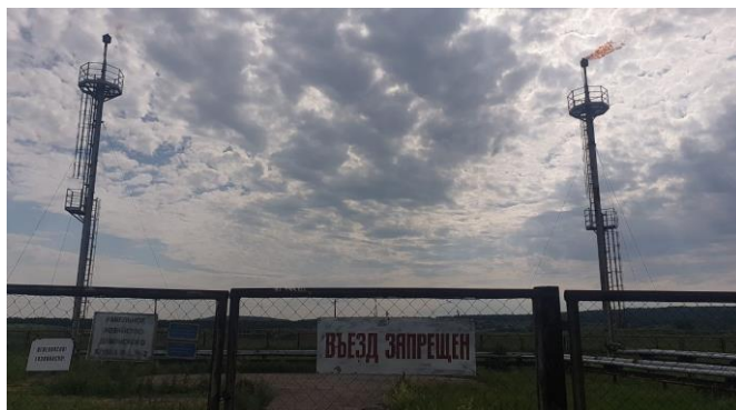
Рисунок 1 – Факельная установка на установке по комплексной подготовке нефти и газа в Башкирии
