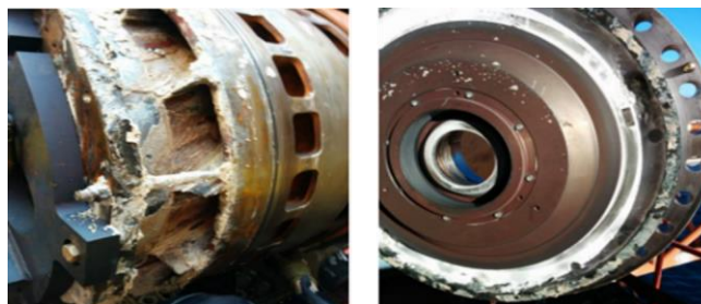
Рисунок 2 – Износ компрессорного оборудования
