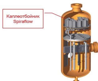
Рисунок 4 – Установка внутреннего устройства Spiraflo в газовый сепаратор
