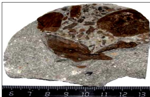
Рисунок 2 – Фотография керна из скв. 8 Ракушечная (интервал 1478,4–1480,07 м) [3, с. 177]
