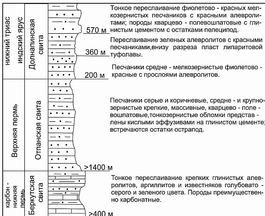
Рис. 2. Геолого-стратиграфический разрез палеозойских отложений Мангышлака
