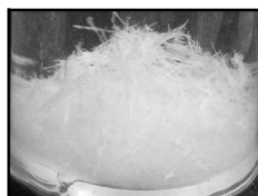
Рис. 7. Процесс формирования осадка солей с кристаллами парафинов
